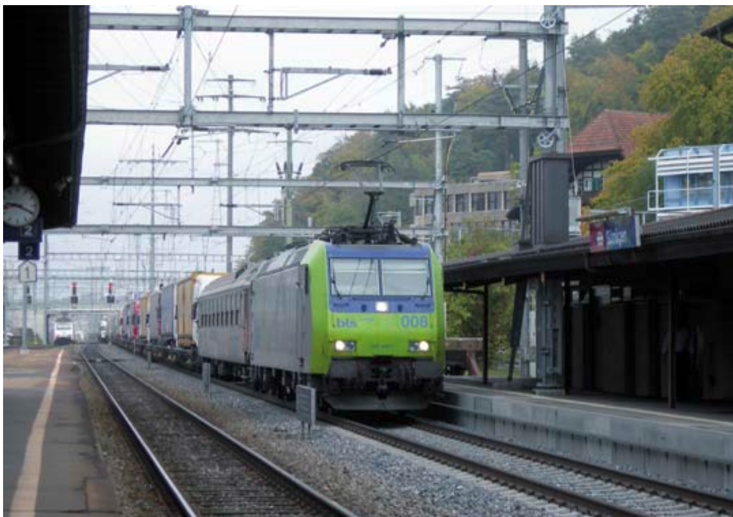
Gümligen: Übergang Dreispur/Doppelspur. Links hinten IC Brig–Bern, Mitte Gleis frei für die S 1 Fribourg–Thun, rechts RoLa Freiburg–Navarra wird noch vor der S-Bahn eingefädelt.
