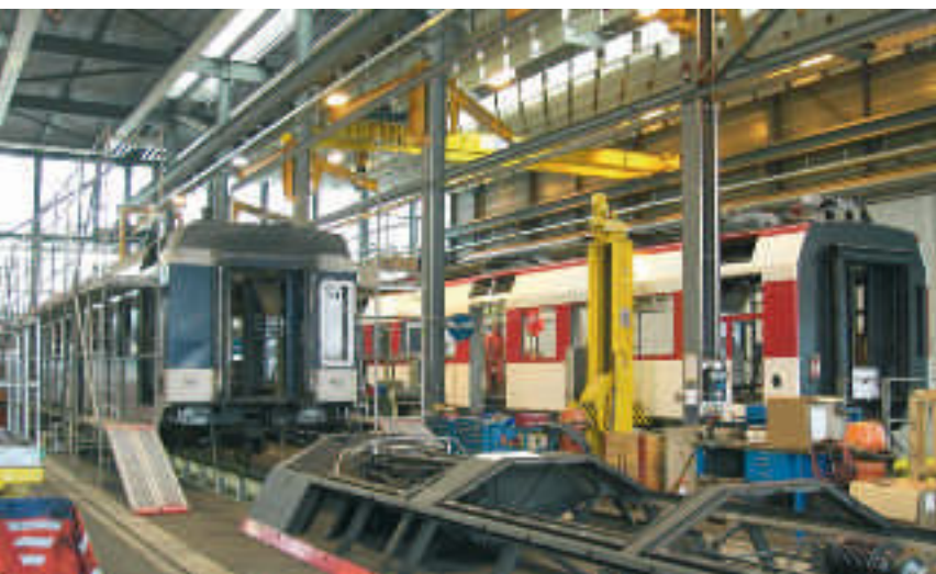
Verjüngungskur in der SBB-Werkstätte Yverdon: Ein alter Triebwagen (links) wird ausgeräumt, ein Domino-Wagen (rechts) befindet sich im Aufbau.
