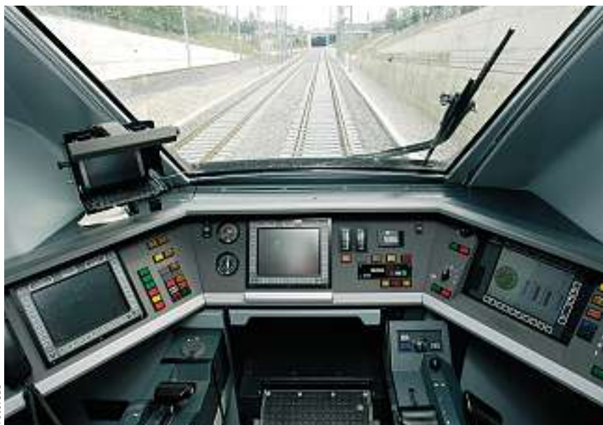
ICN-Führerstand mit ETCS. Bei Hochgeschwindigkeiten können Aussensignale nicht mehr wahrgenommen werden; der Lokführer braucht die Führerstands-signalisierung.
