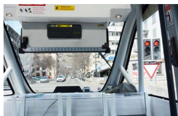
Bei Lichtsignalanlagen muss der Begleiter dem „SmartShuttle“ von Hand den Haltebefehl und den Befehl zur Weiterfahrt erteilen.
