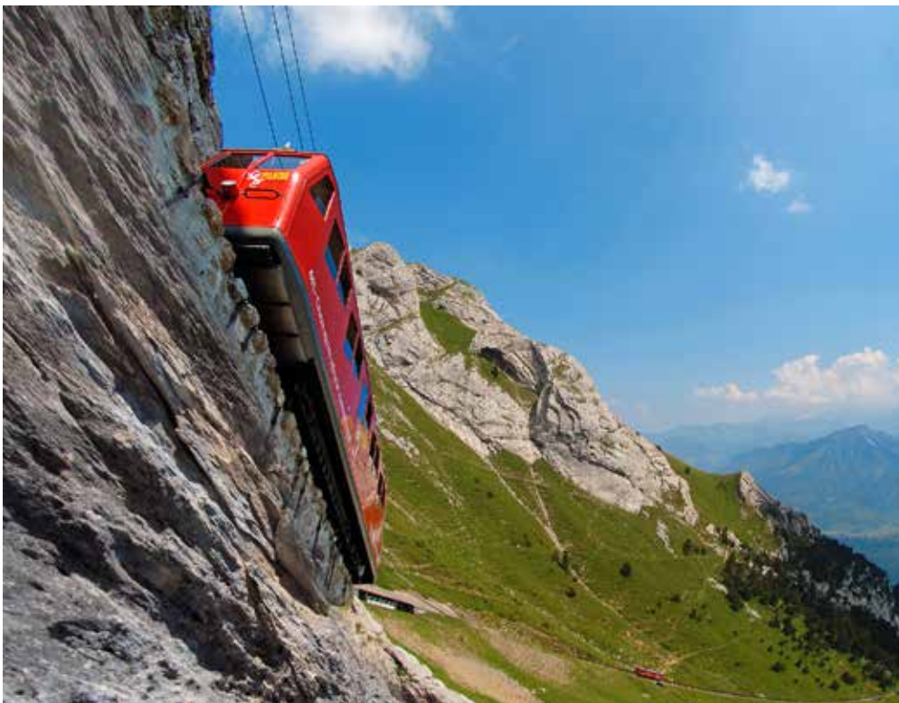
Die steilste Zahnradbahn der Welt: Bis 48 Prozent Steigung auf einer Strecke von 4,6 Kilometern.
