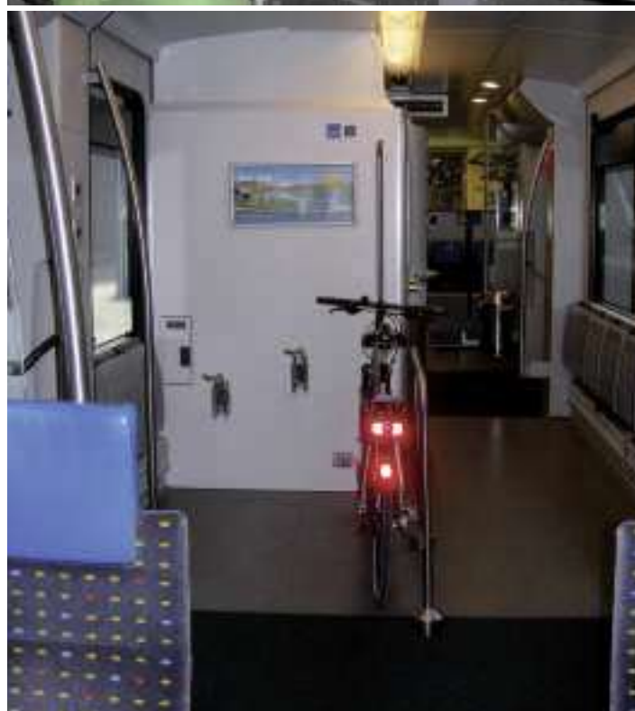
Oben: Velohaken über Kofferngestell/Skihalterung über Kinderwagen der Reisenden: schlechtes Beispiel im ETR 610. Unten: Optimales Multifunktionsabteil im Flirt SBB Basel-Lörrach.
