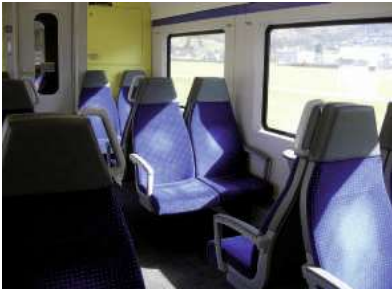
Unterschied 2./1.Klasse im Regionalverkehr: lediglich Sitzabstand, Polsterfarbe, Mittelarmlehne und Kopfschutz. Schlechtes Beispiel: Innova-Zwischenwagen der renovierten Domino-Pendelzüge (u. a. Glarner-Sprinter) der SBB. Sitzbänke hart und unbequem, fehlende Kleiderablage über dem Fenster, ungenügende Schallisolation.
