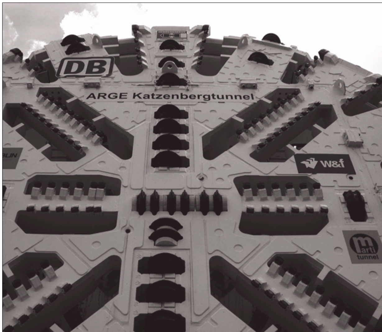
Imposanter Bohrkopf der Tunnelbohrmaschine, die in 30 Monaten den 9,4 Kilometer langen Katzenberg durchfräsen wird.
