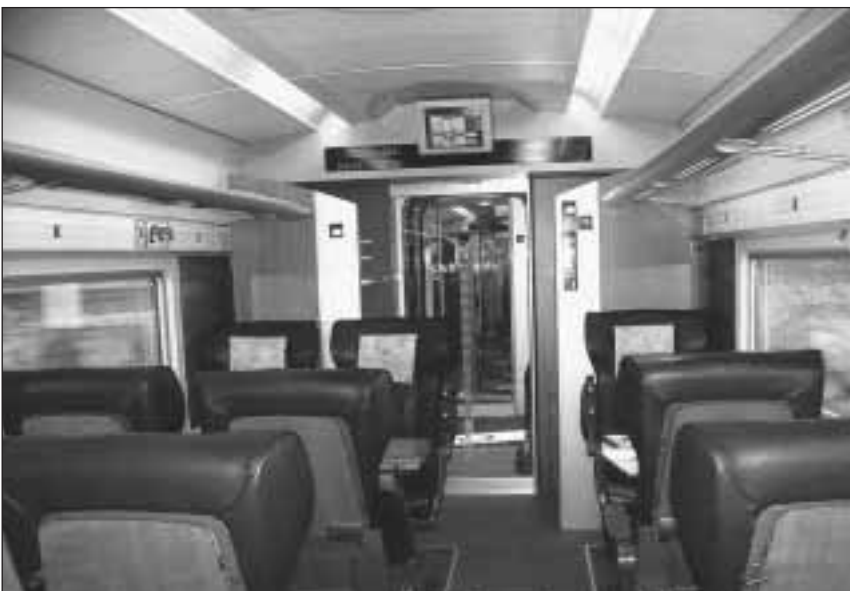
Der AVE S-102 bietet drei Komfortklassen (hier Club). In allen drei sind Videosysteme installiert, welche Geschwindigkeit und Position anzeigen.
