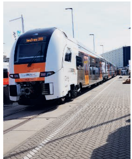
Doppelstocktriebzug Kiss von Stadler für Mälab in Schweden (ganz oben); Siemens Desiro HC für den Rhein-Ruhr-Express, ein vierteiliger Triebzug mit zwei einstöckigen Steuerwagen und zwei Doppelstock-Mittelwagen.
