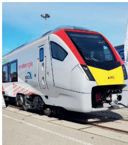
Drei weitere Stadler-Produkte: Klimatisierter Triebzug für die S-Bahn Berlin mit besonders ergonomisch geformten Sitzen in Vierersitzgruppen (oben); U-Bahn für den vollautomatischen Betrieb der Metro Glasgow mit einer Spurweite von 1219 mm (Mitte); Flirt BMU (Antrieb mit Strom oder Dieselgenerator) für Abellio Greater Anglia in Grossbritannien (unten). Bilder: Hans Rothen/Edwin Dutler
