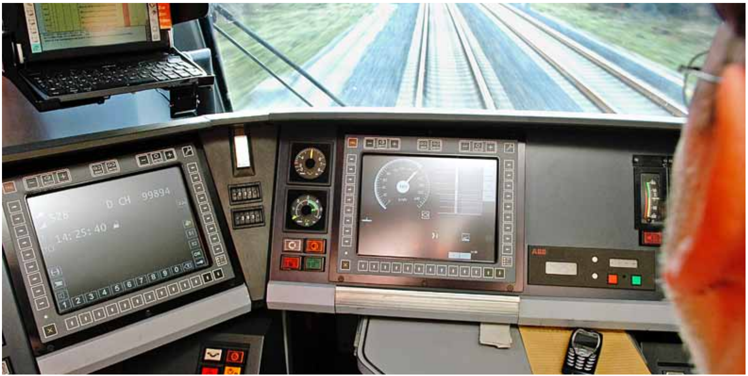
ETCS: Garantiert einen europaweiten Sicherheitsstandard und eine dichtere Zugabfolge.
