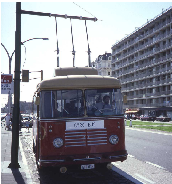
Gent um 1958: ein Gyrobus beim Aufladen des Schwungrades.
